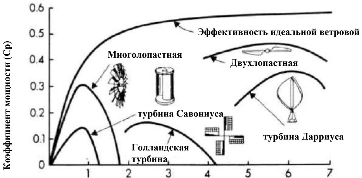
Рис. 28 – Сравнение производительности типов ветровых турбин
