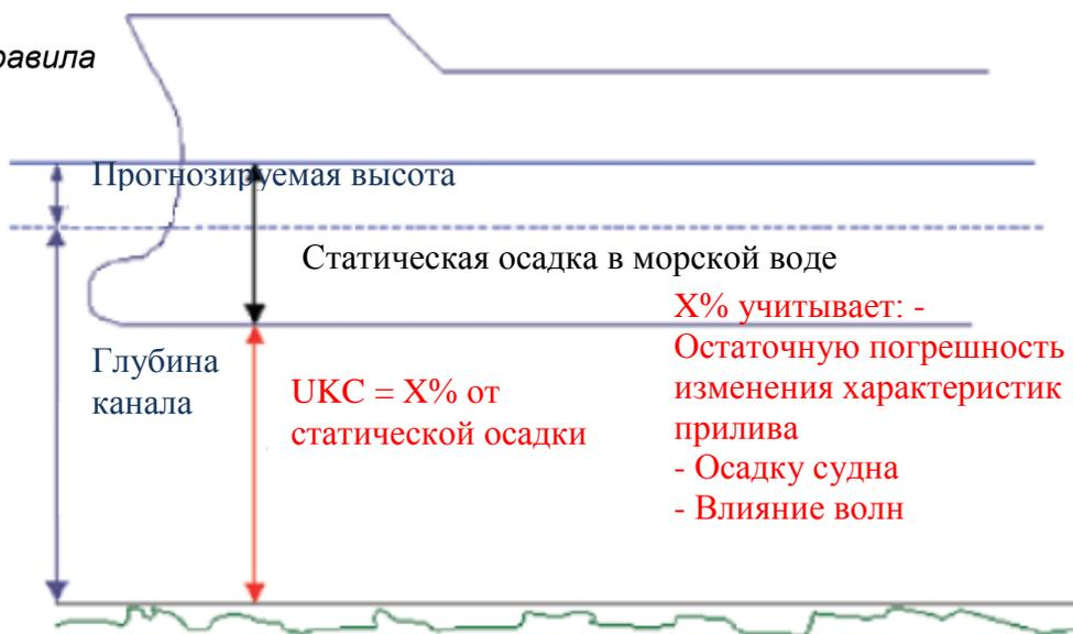
Рис. 27 – Измерение УГК, основанное на данных в реальном времени для каждого элемента
