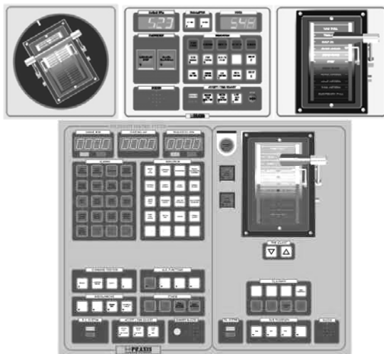
Рис. 6.3. Панель управления главным двигателем, носовым поперечным и кормовым азимутальными подруливающими устройствами
