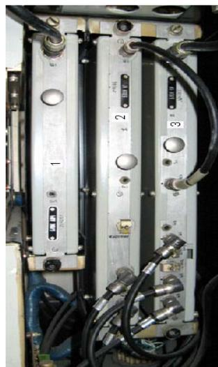
Рис. 52. Блок АПЧ и два усилительных блока приемника:
