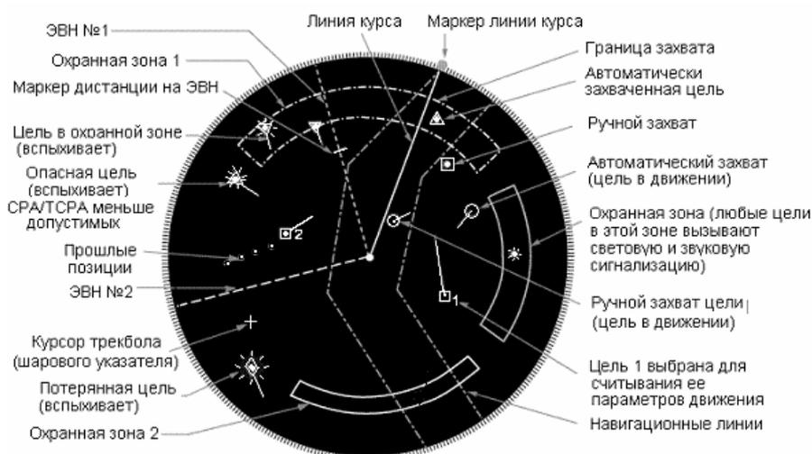
Рис.9.2. Пример отображения графической вторичной информации в САРП серии FAR 25x5
